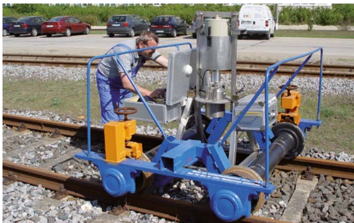
Abb. 36: Messung zur Freigabe von Außenflächen
