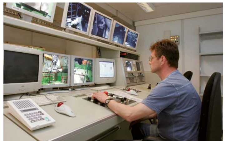
Abb. 29a: Fernhantiertes thermisches Schneiden (Steuerstand für fernbediente Arbeiten)
