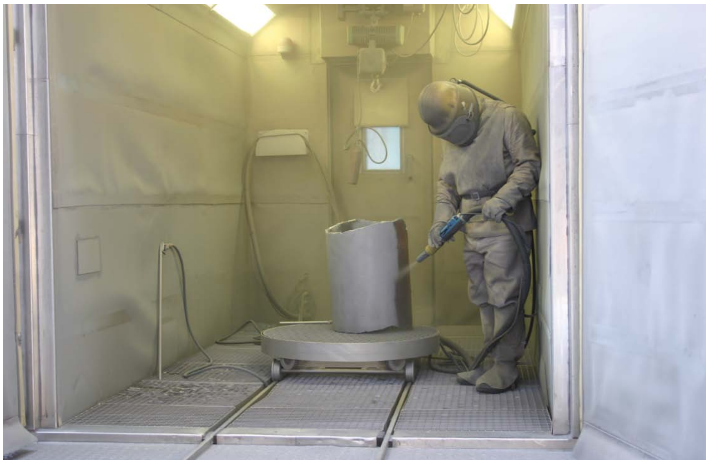
Abb. 27: Dekontamination mittels Sandstrahlen
